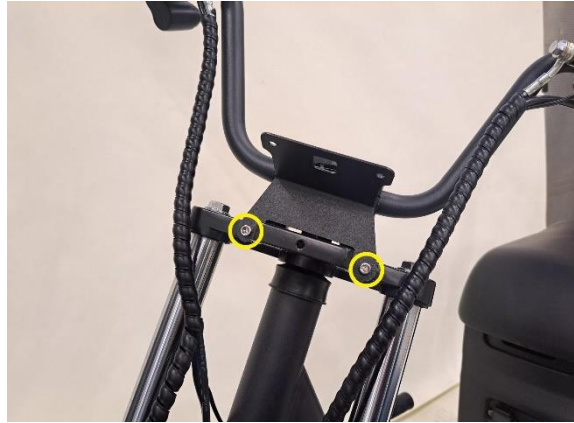
Irrota mittariston kiinnikkeen kiinnityspultit (kuusiokoloavain 4 mm).
