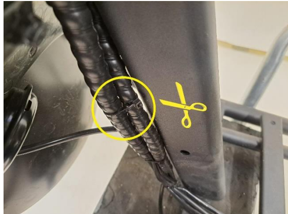
Katko kaikki mittariston johtoja kiinni pitävät nippusiteet (sivuleikkurit).
