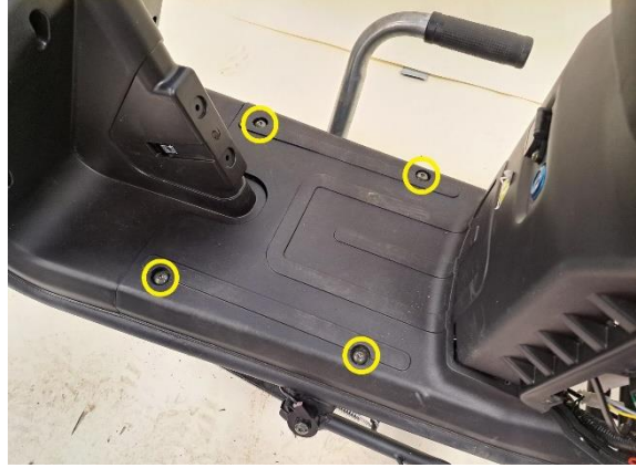
Irrota jalkatilan muovin kiinnityspultit (kuusiokoloavain 5 mm).
