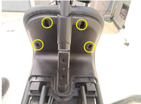
Irrota jalkatilan etuosan muovin kiinnitysruuvit (ristipäämeisseli ph2).
