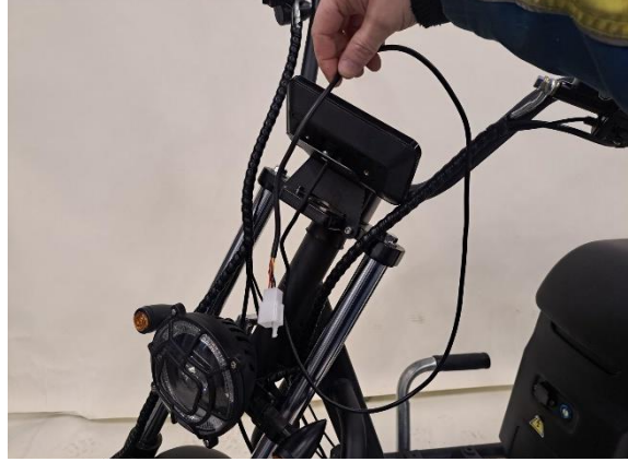
Pujottele mittariston johto irralleen.
