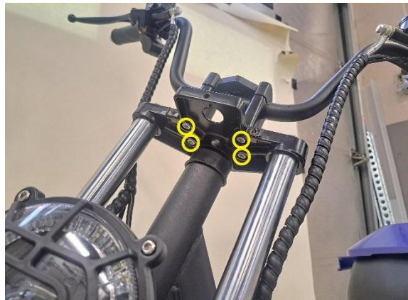
Irrota ohjaustangon kiinnikkeen kiinnityspultit (kuusiokoloavain 6 mm).
