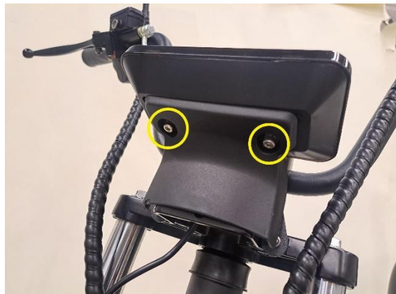
Irrota mittariston taustamuovin kiinnityspultit (kuusiokoloavain 4 mm).
